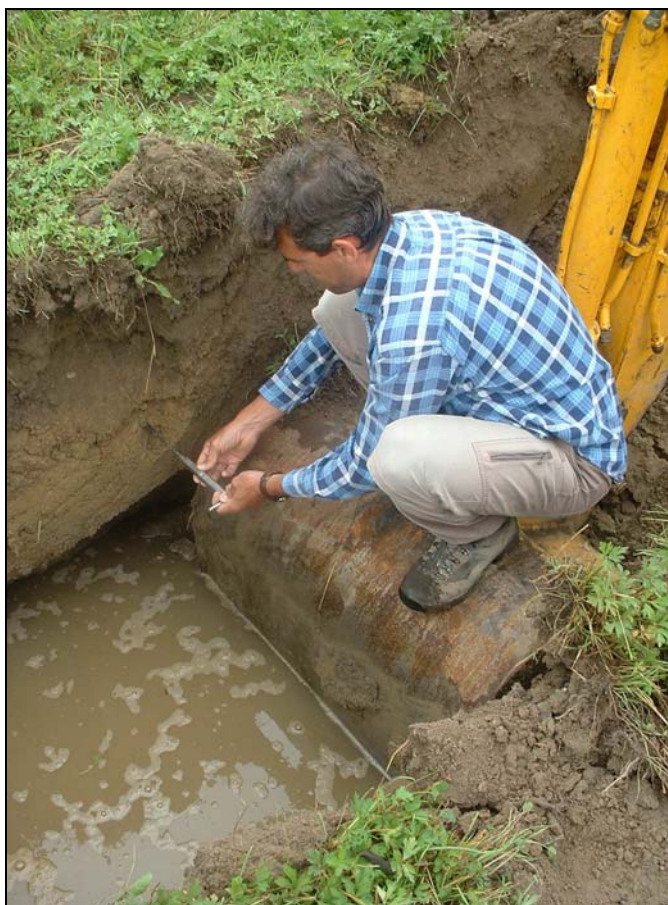
Trincea geognostica T1 Esecuzione prova scissometrica (vane test) lungo la parete dello scavo della trincea
